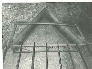
鉄筋などで補強 マニアホークの爪を 下に忍ばせ持上げる
