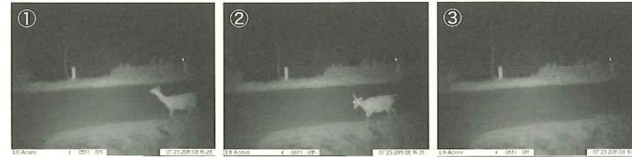
写真2 エゾシカ忌避の様子 ①エゾシカが出没 ②装置から光と音が発せられる ③エゾシカが逃げる
