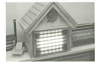
写真3 LEDの光と音でエゾシカを撃退(デモ機)
