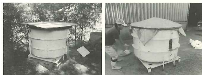
装置の外形寸法：1,65m(L)×1,55m(W)×1,20m(H) 218kg
