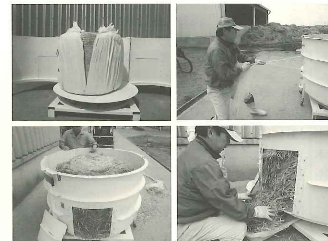
側面カバーが3分割に開く 底がターンテーブルになって左右自在に回転する ターンテーブルの直径：1,40m 対応ロールベールサイズ：直径 1,00m × 1,00m 約400kgまで
