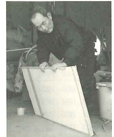
(写真4) 発泡スチロール、電気毛布、PPプレートをガムテープで固定して完成する
